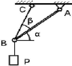
2. Груз весом  $P = 10 \text{ Н}$  подвешен на двух тросах  $AB$  и  $BC$ , составляющих с горизонтальной прямой углы  $\alpha = 15^\circ$  и  $\beta = 30^\circ$ . Определить усилия в тросах.
